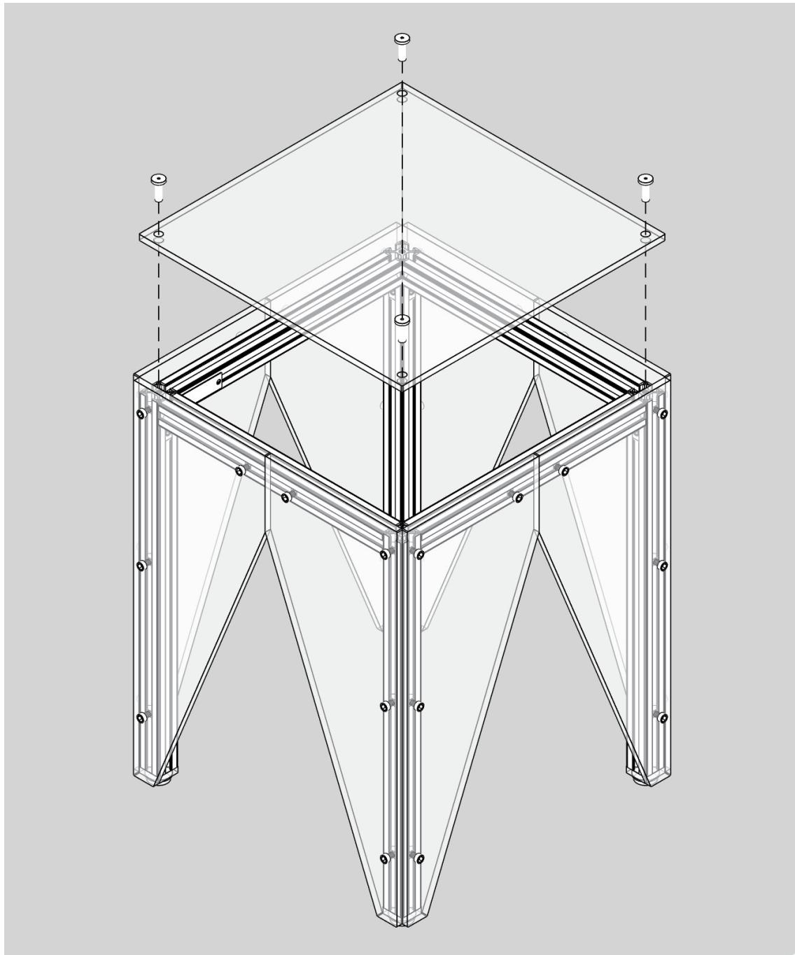
3. 最简单的组装方式即为先将面板放入侧板围成的上部空间内，再将面板螺丝穿过面板上的孔位与立柱连接。
