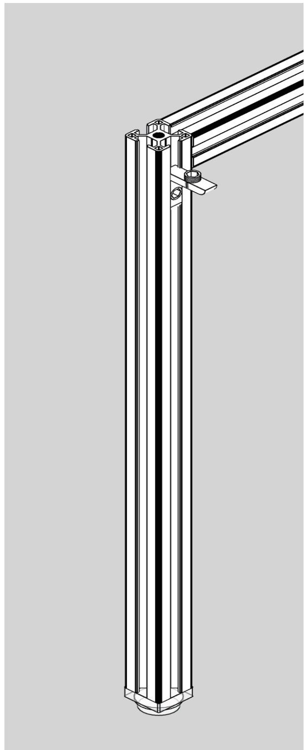
7. 调整内置角槽的高度使得横梁上方与立柱上方齐平。继续连接其他立柱，完成结构框架。
