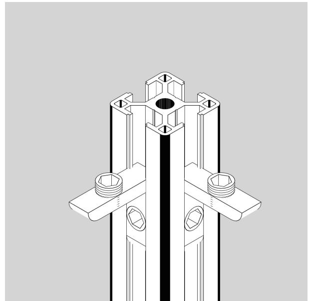
3. 将内置角槽从上端滑入铝型材槽中轻轻固定，不要拧到底。
