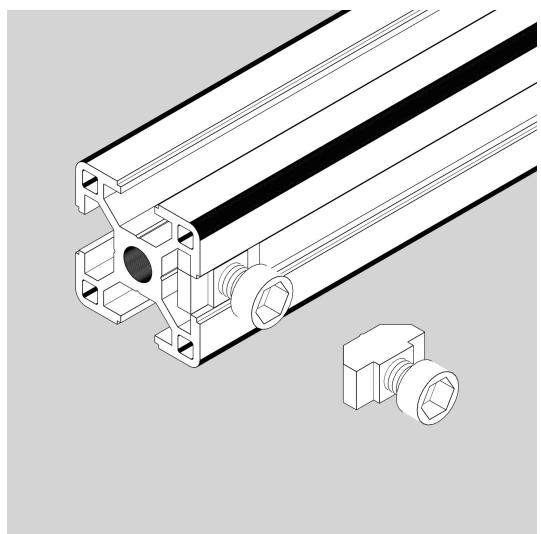
2. 船型螺母方向与铝型材槽的方向相同放入槽内。
