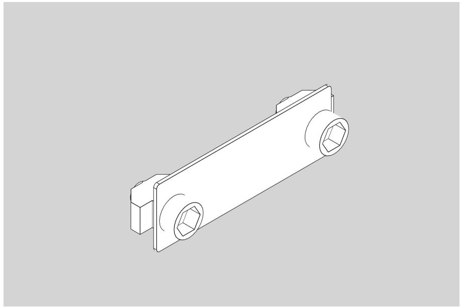
2. 铭牌组装完成形态。可以安装在您觉得合适的地方。我们推荐您安装在横梁内侧或下方，保持低调。
