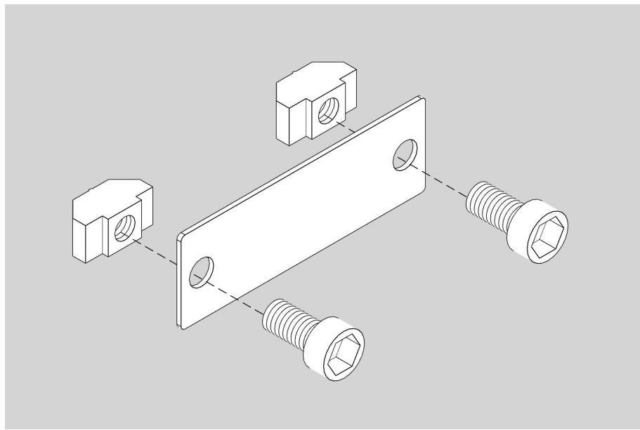
1. 取两组内六角螺丝和船型螺母，穿过铭牌两端的孔连接。注意，螺丝不要拧紧。
