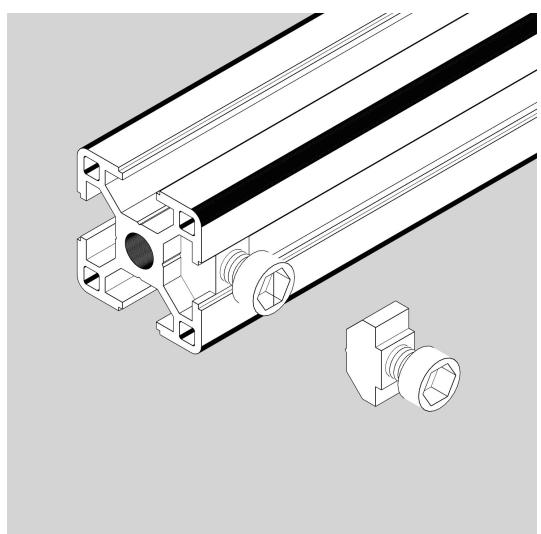
3. 旋转内六角螺丝使船型螺母方向转为垂直于铝型材槽的方向。
